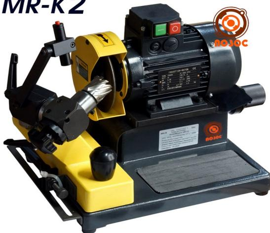
Заточной станок для корончатых сверл диаметром до 52 мм, с хвостовиком Weldon 19.
